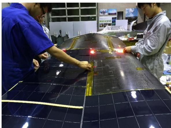
Fig.17 配線用リセス (絶縁用カプトンテープの箇所)
